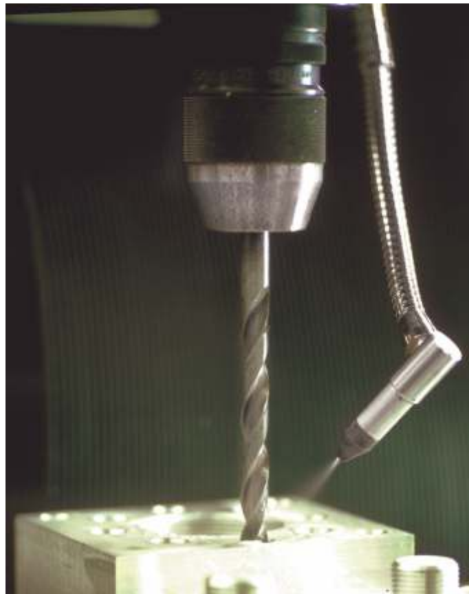
Szerszámhűtés és -kenés környezetkímélő levegő-köpenyben
